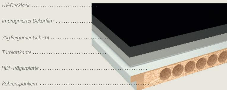
Zur Herstellung von diesem exklusiven Beschichtungsmaterial wird ein CPL Schichtstoff mit einem innovativen Lackierverfahren weiterveredelt, welches exakt auf die Oberfläche abgestimmt wurde. Beim täglichen Umgang müssen Türen und Zargen mit der Nanoline Oberfläche daher mit lackierten Möbeloberflächen gleichgesetzt werden.
